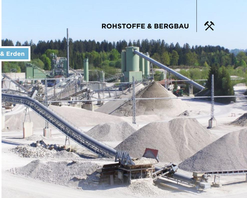
**FOTO:** M. Müller, Werk Oberland Rolf Strohmaier, Huglfing | Abbaukonzentration mit Rohkiesgewinnung, Aufbereitung und Weiterverarbeitung zu Asphalt und Transportbeton
