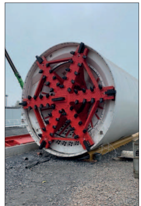
Bild 4: Tunnelbohrmaschine mit Schneidrad Quelle: Bezirksregierung Arnsberg
